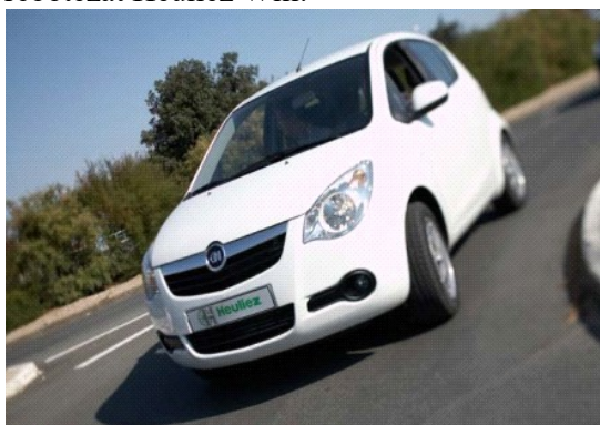
Figura 3. Heuliez Will - un Opel Agila cu doua roti electrice [5]
