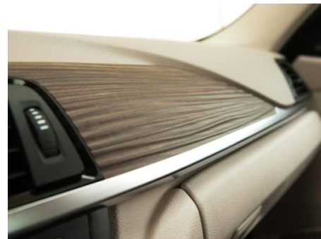
Fig. 17 Bord automobil cu suprafață microprofilată spațial din materiale compozite cu aspect de lemn
