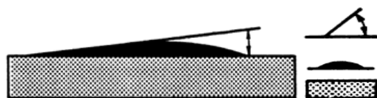
Fig. 4a. Hartii netratate și cu încheiere slabă: tensiune superficială în stratul limită slabă = udare bună
