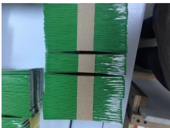
Fig. 1. Crapături la suprafața tipărită a pliantelor
