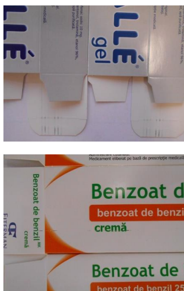
Fig. 6. Neconformități datorate urmelor de cerneala
