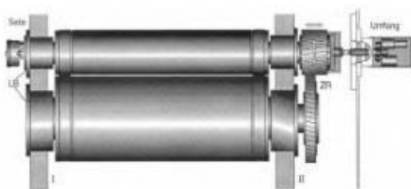
Bild 7/25a. Lagerung, Antrieb und Registerantrieb von Zylindern (MAN Roland, ROTOMAN M). Umfangs- und Seitenregister-Vorantrieb
