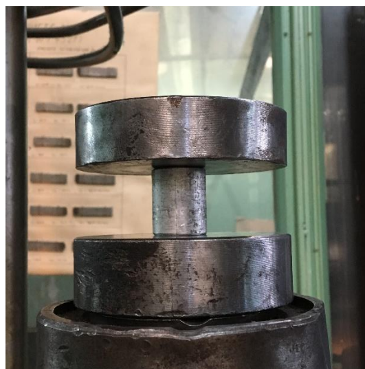
Fig. 7 Pozitionarea piesei in vederea deformatiei plastice pe presa
