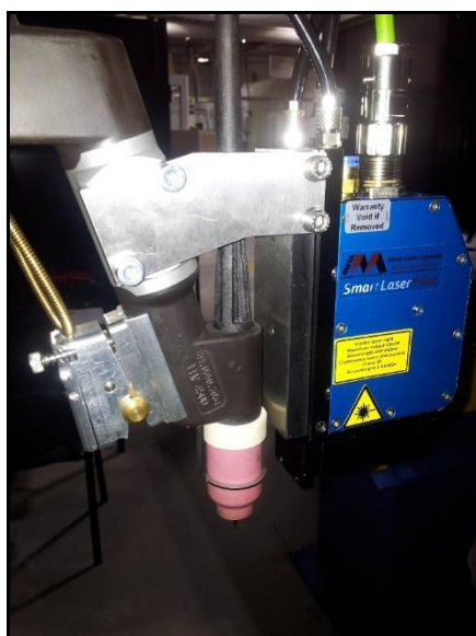
Fig. 4. Sistem pentru urmărirea rostului Meta Vision și Pistolet de sudare – FRONIUS Robacta TTW4500 PAP
