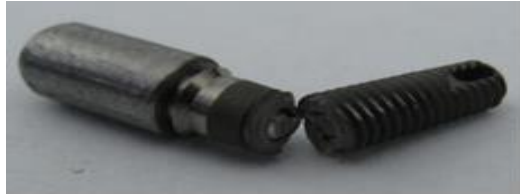
Fig.7. Specimene rupte în timpul testelor la oboseala
