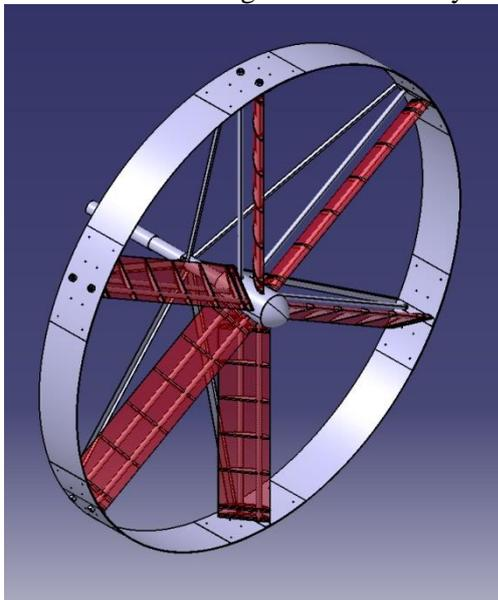
**Fig. 5. Highlighted blades of the rotor**
