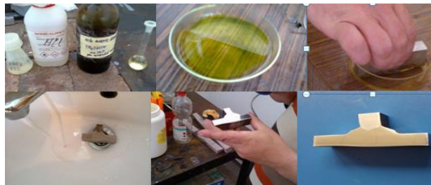
Fig. 10. Preparare reactiv pentru proba sudată cap la cap și înglobată în rasina: 10g (COOH) 2 2H 2 O; 100ml H 2 O și efectuare atac electro-chimic, utilizând sursa curent stabilizată TXN 1502
