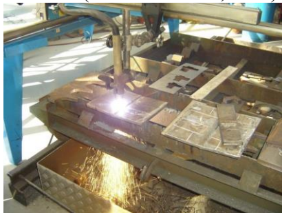
Fig.6. Debitarea cu plasma, masina Novitome
