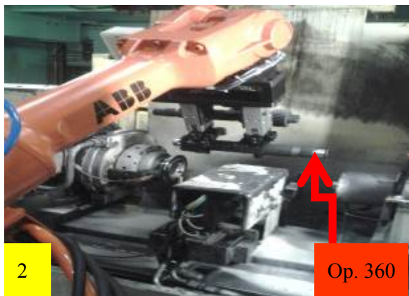
Fig.31. Incarcare descarcare op. 360 rectificarea cote rulmenti
