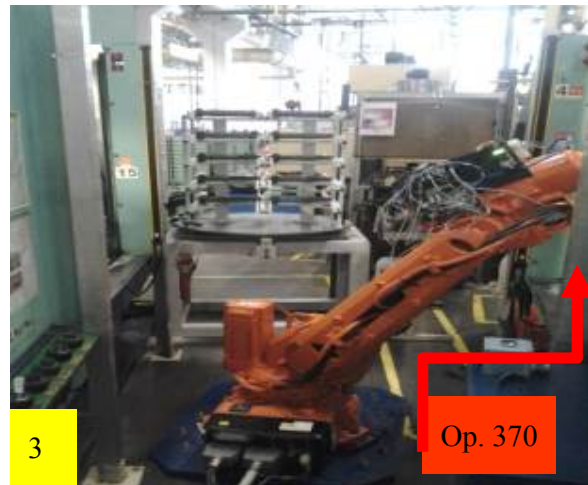
Fig.32. Incarcare descarcare op. 370 rectificarea caneluri
