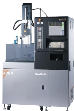
Figura 5. Mașini de electroeroziune de realizare a găurilor Sodick [11]
