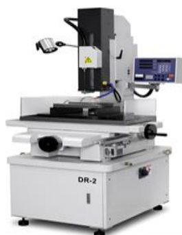
Figura 6. Mașini de electroeroziune de realizare a găurilor Ona DR-2 [12]
