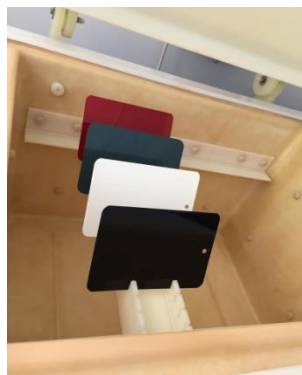
Fig. 3 Cele 4 probe fixate în rastelul camerei de ceață
