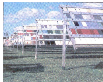
Fig.1 Expunere în atmosfera naturală pe cadre speciale standardizate
