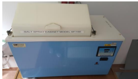
Fig.2 Camera de simulare a atmosferelor corozive (Laboratorul de Ecologie Industrială și corozivune, catedra TCM, IMST, UPB)
