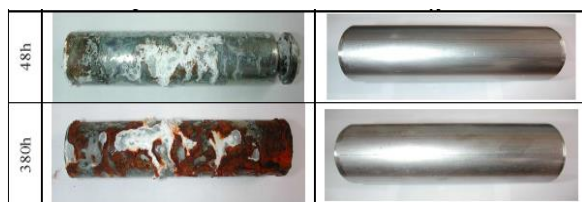
Fig. 5 Oțel-carbon electrogalvanizat(stânga) și oțel inoxidabil AISI 441(dreapta) testate în cameră de ceață
